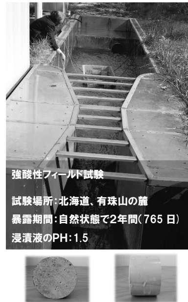
図-5 強酸性フィールド試験状況と試験後のコンクリート内部
