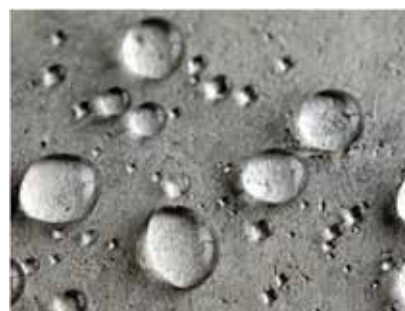
図-2 シラン系含浸材の表面撥水効果
