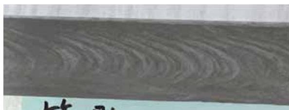
写真-3 破断面のストライエーション
