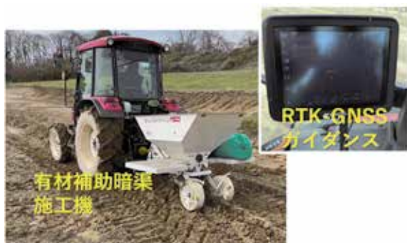
写真－2 暗渠位置情報を活用した暗渠機能長寿命化技術
