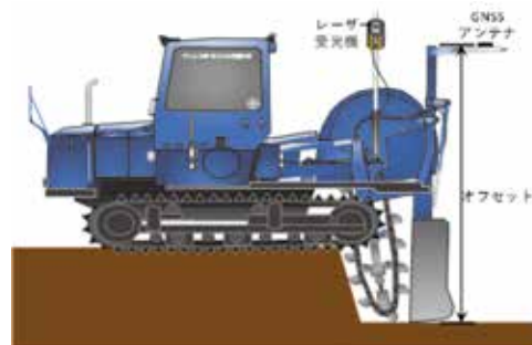
図－３ 暗渠埋設管の位置情報取得方法
