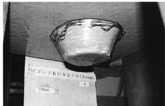
図-3 押抜き試験状況
