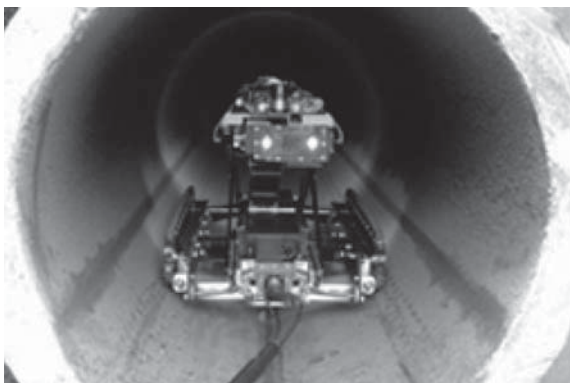
写真-4 衝撃弾性波+カメラ映像を得られる調査機器
