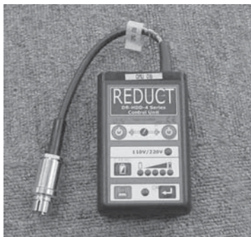
写真-2 コントローラー 管内走行装置のON/OFF、データ制御に使用する。
