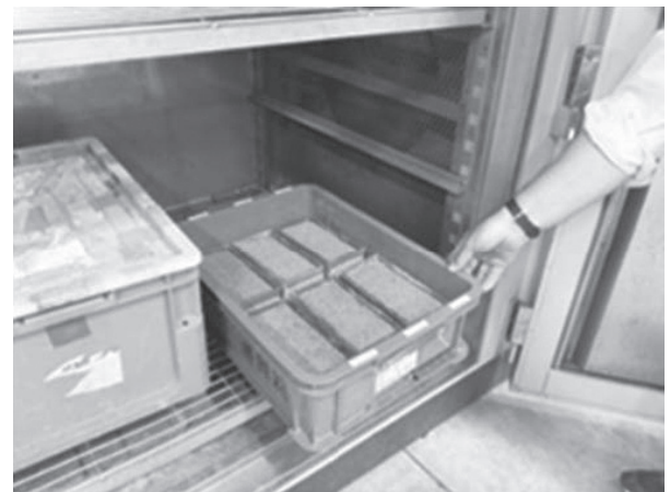
写真-4 試験体の乾燥工程
