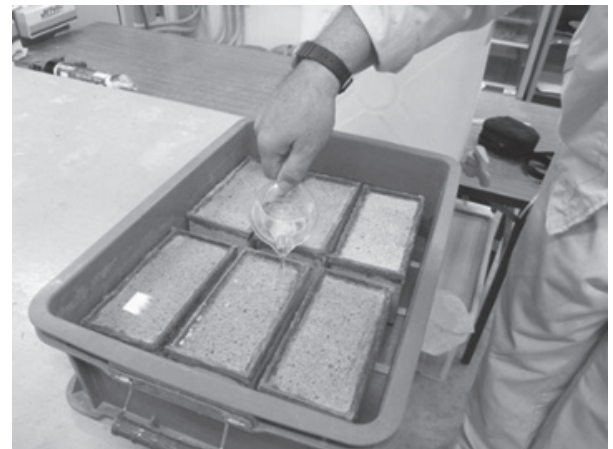
写真-3 塩水滞留工程
