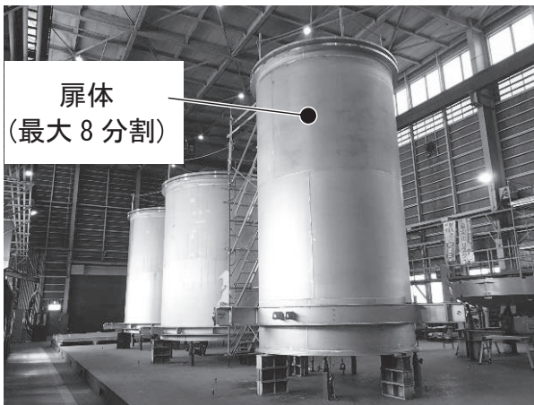
図-1.6-1 工場一体組立状況
