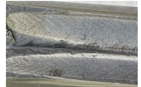
写真3-6 破断面の拡大
