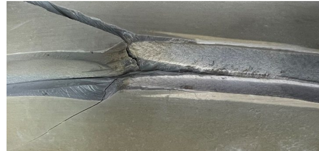
写真3-5 破断したVHφ250 破断面
