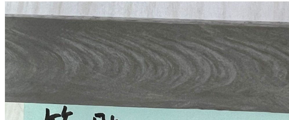
写真3-7 破断面の（ストライエーション）
