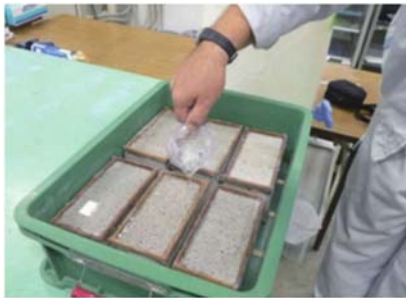
塗布面に塩水を漏水
