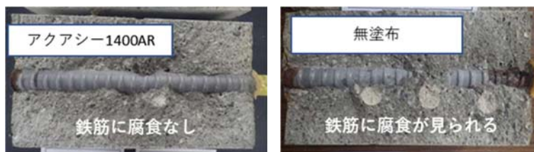
腐食促進試験67サイクル後の鉄筋腐食状況
