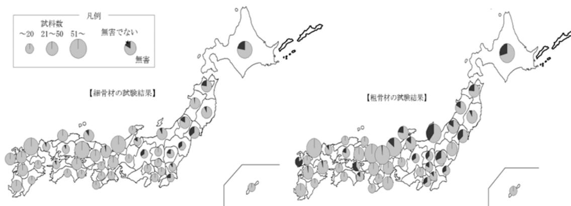
図 3.3-18 骨材のアルカリシリカ反応性試験結果
