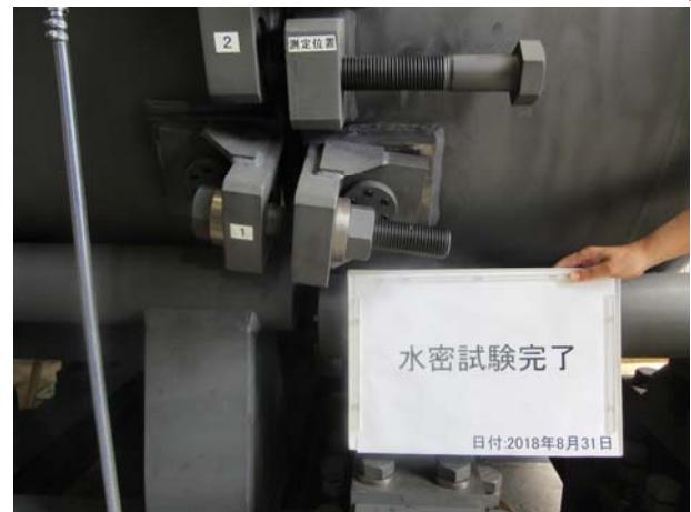
複合変位(目開き変位40mm+屈曲変位1°)時の止水試験手順例
