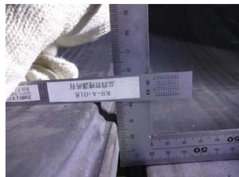
段差変位(40mm)時の止水試験手順例
