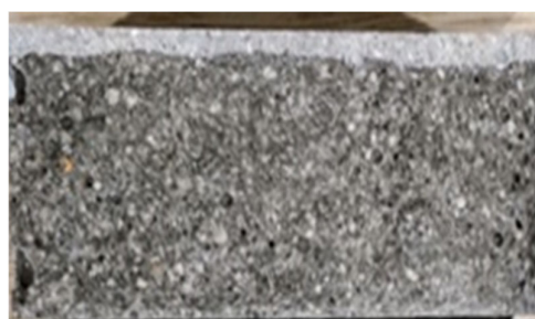
ミラクルコート(無溶剤) 浸透深さ6.3mm (塗布量 230g/m 2 )
