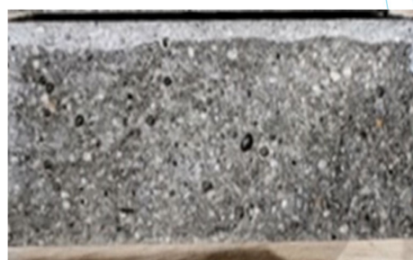
ミラクルコート(水性) 浸透深さ6.3mm (塗布量 230g/m 2 )
