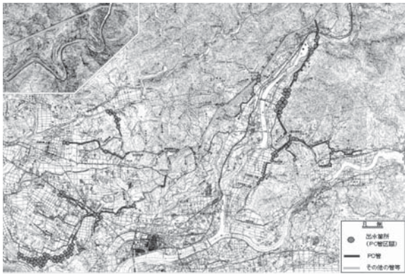
図-1 右岸地区のPC管における出水箇所
